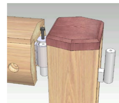
Verrouillage des panneaux de barreaudage sur les poteaux
